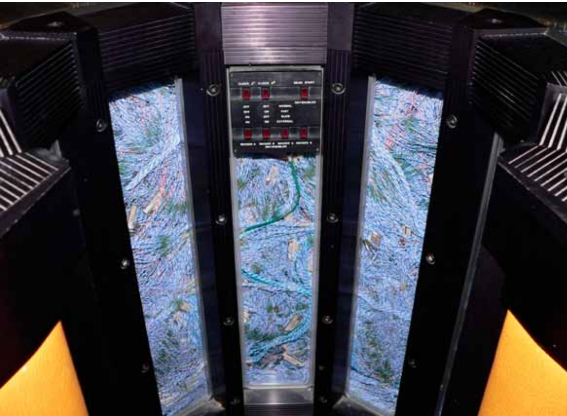
Unser Titelbild: Blick in eine Cray-2. Die Cray-2 war ein Vektorsupercomputer, der 1985 von Cray Research gebaut wurde. Sie war die Weiterentwicklung der Cray-1 und bei ihrem Erscheinen der weltweit schnellste Rechner.
